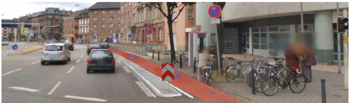
Abbildung 1: Visualisierung eines Radfahrstreifens als Protected-Bike-Lane.
